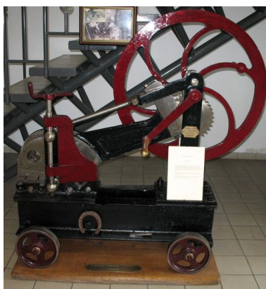
Machine à main utilisée pour redresser les fers et pour fabriquer les fers en I, en T, les ronds et les cornières. Phot. Clarisse Lorieux IVR22_20076005259NUCA
