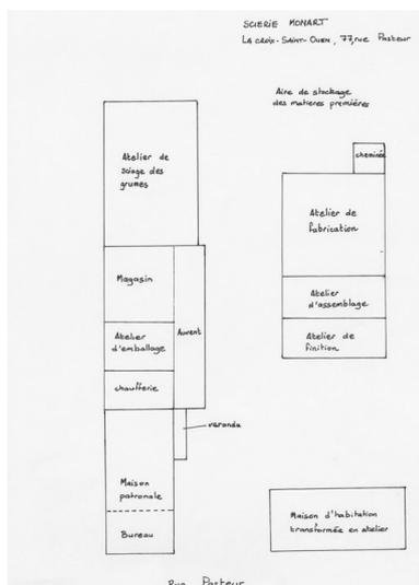
Plan schématique indiquant la fonction des bâtiments.
