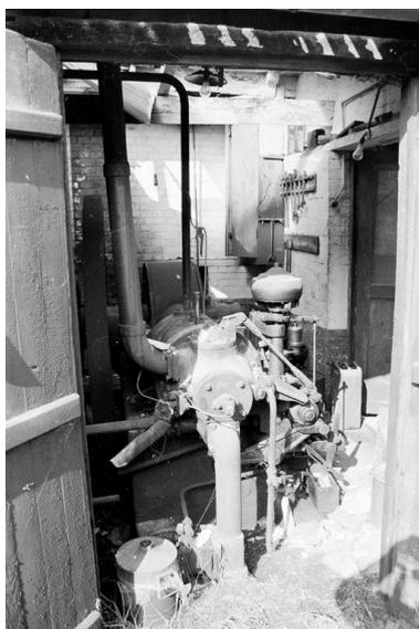
Moteur à pistons à combustion
