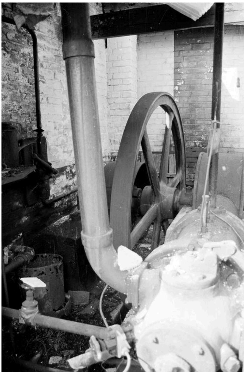
Moteur à pistons à combustion (machine à pression d'huile) : détail du volant de transmission.
