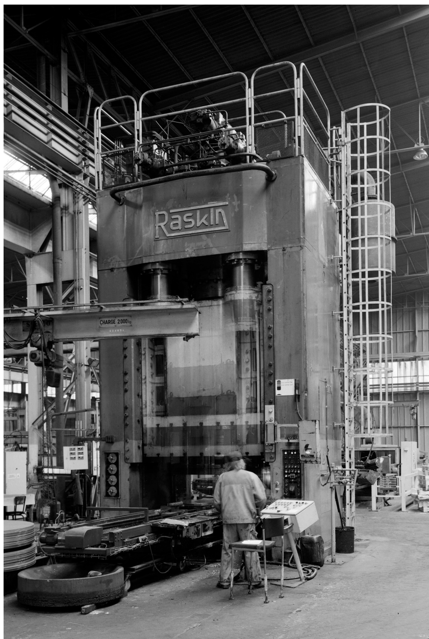
Hall 5 : vue générale de la presse à froid Raskin, 2 000 tonnes, emboutissant des tôles de 1 000 à 1 900 mm.
