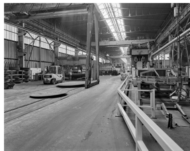
Hall 5 : la finition des fonds et l'ajustage, la presse à froid Raskin (premier plan, à droite). Phot. Thierry Petitberghien IVR31_20025901405V
