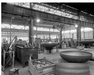
Hall 7 : la mise à hauteur au chalumeau. Phot. Thierry Petitberghien
