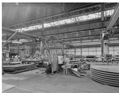
Hall 2 : le soudage et le découpage des tôles avant emboutissage. Phot. Thierry Petitberghien IVR31_20025901406V
