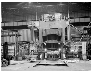
Hall 6 : vue générale de la presse Loire, 2 600 tonnes, emboutissant à froid et le four (à gauche). Phot. Thierry Petitberghien IVR31_20025901410V
