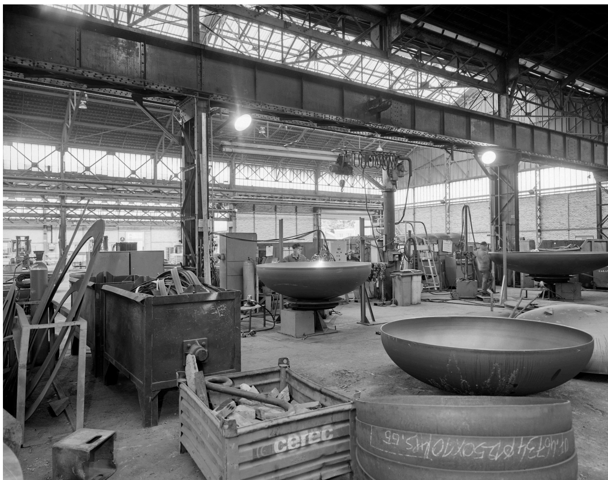
Hall 7 : la mise à hauteur au chalumeau.
