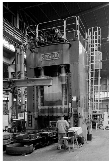
Hall 5 : vue générale de la presse à froid Raskin, 2 000 tonnes, emboutissant des tôles de 1 000 à 1 900 mm. Phot. Thierry Petitberghien IVR31_20025901417X
