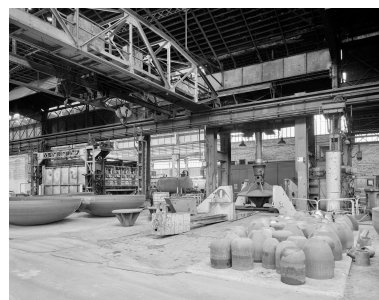
Hall 7 : vue générale de la machine à former et les galets (au premier plan). Phot. Thierry Petitberghien IVR31_20025901397V
