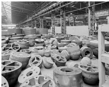
Halls 8 et 7 : les moules pour presses (premier plan) des fonds emboutis (dans le prolongement), le four (à droite, derrière les panneaux) et la presse 1 500 tonnes (dans le prolongement du four). Phot. Thierry Petitberghien IVR31_20025901400V
