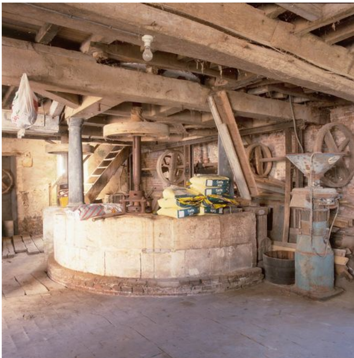
Le beffroi et le mécanisme de transmission principal.
