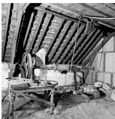
Moteur du monte-sacs de la malterie. Phot. Olivier Marlard
