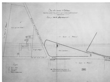
Plan de la sucrerie d'Acheux. Installation du four à chaux de l'usine à gaz et du four à revivifier le noir animal, 1866 (AD Somme ; M 81728).
