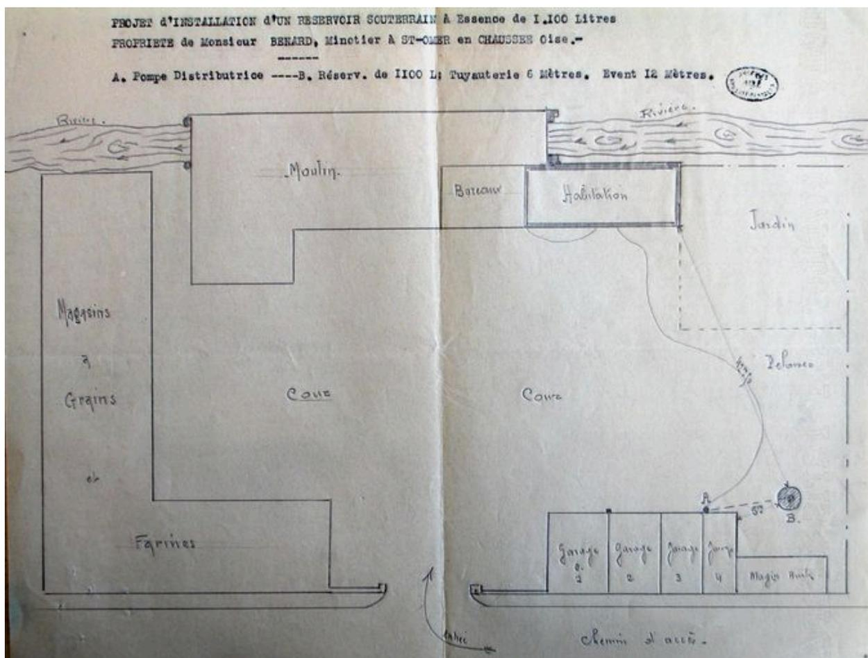
Plan schématique de la minoterie Bénard pour l'installation d'un dépôt souterrain d'essence, 1935.
