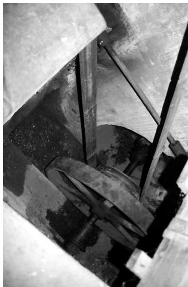
Détail de la première transmission à la sortie de la turbine.
