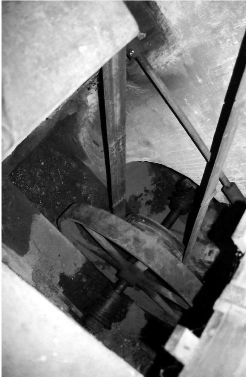
Détail de la première transmission à la sortie de la turbine.
