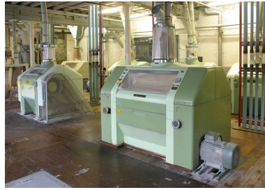
Premier étage de la minoterie : appareils à cylindres Golfetto. Phot. Frédéric Pillet IVR22_20050205179NUCA
