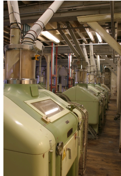
Premier étage de la minoterie : appareils à cylindres Golfetto. Phot. Frédéric Pillet IVR22_20050205180NUCA
