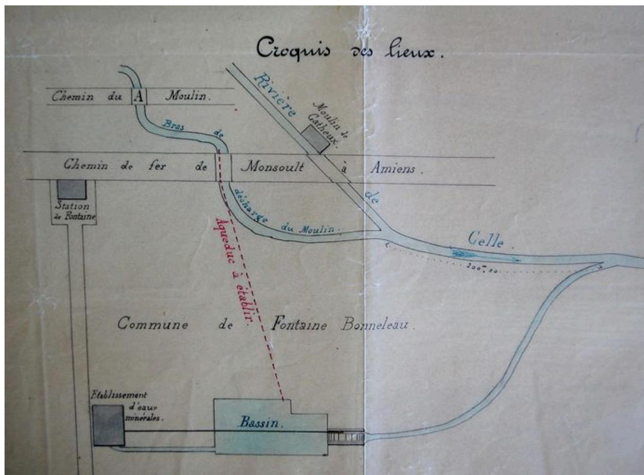
Plan détaillé de l'établissement de M. Recourat par Pierre (ingénieur ordinaire des Ponts-et-Chaussées, annexé à la demande de détournement des eaux du bras de décharge de la Celle pour alimenter un bassin de retenue.
