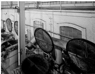
Vue intérieure de l'atelier de cristallisation, détail des cuites ouvertes. Phot. Patrick Glotain IVR22_19936000725V
