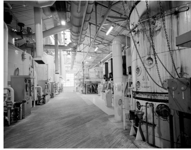
Atelier de cristallisation, vue des cuites. Phot. Patrick Glotain IVR22_19936000723V
