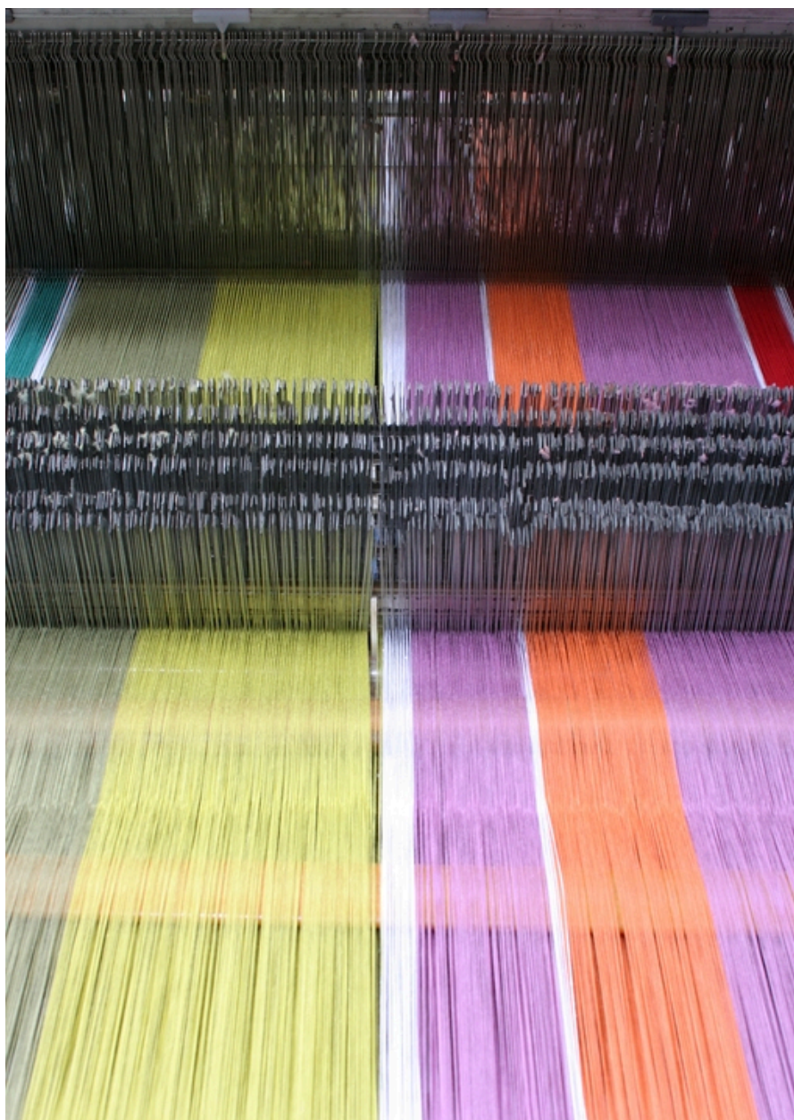
Machine à tisser à lances et ratière. Casse-chaînes et lames de lisses à l'arrêt.
