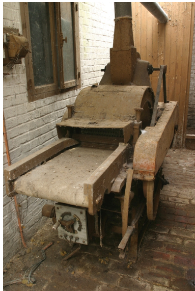
Petite cour couverte à l'arrière de l'atelier de 1900 : machine Bonduelle (Lille), destinée à la préparation de matières textiles. Phot. Frédéric Pillet IVR22_20050205560NUCA
