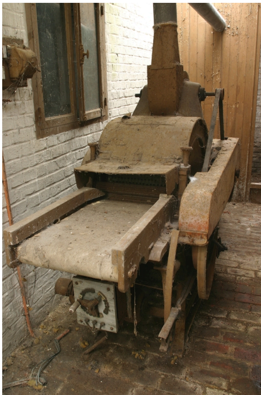
Petite cour couverte à l'arrière de l'atelier de 1900 : machine Bonduelle (Lille), destinée à la préparation de matières textiles.
