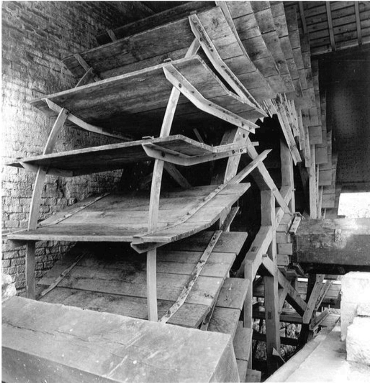
Détail de la roue hydraulique verticale.
