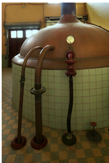
Détail des tuyaux et du manomètre Diebold de l'une des cuves de brassage. Phot. Thierry Lefébure IVR32_20168000087NUC2A
