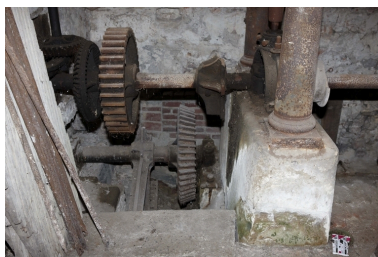
Vue de l'arbre moteur et des embrayages coniques (endommagés). Phot. Pierre Thibaut IVR31_20095902645NUCA
