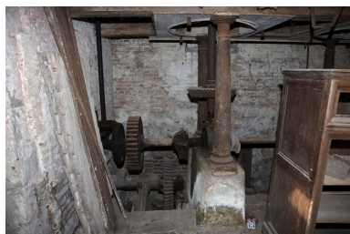
Vue de l'arbre moteur et des embrayages coniques (endommagés). Phot. Pierre Thibaut IVR31_20095902645NUCA
