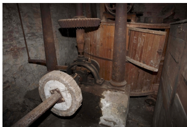
Vue de l'embrayage et de l'archure. Phot. Pierre Thibaut IVR31_20095902646NUCA
