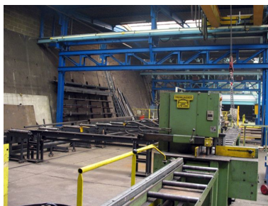
Machine de coupe et de perçage des charpentes. Phot. Clarisse Lorieux IVR22_20076005249NUCA
