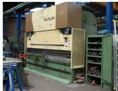
Machine à presser dans l'atelier de serrurerie. Phot. Clarisse Lorieux IVR22_20076005251NUCA
