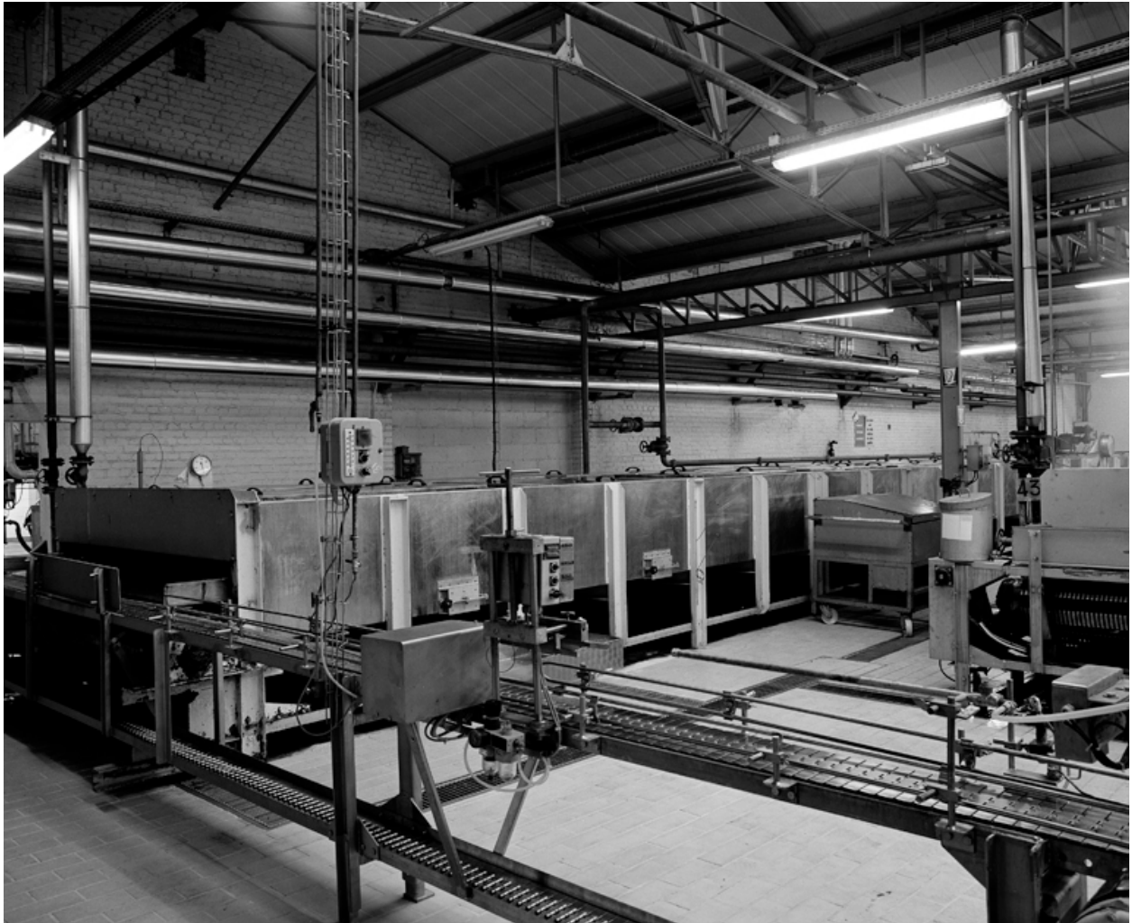
Machine servant à pasteuriser les pots.
