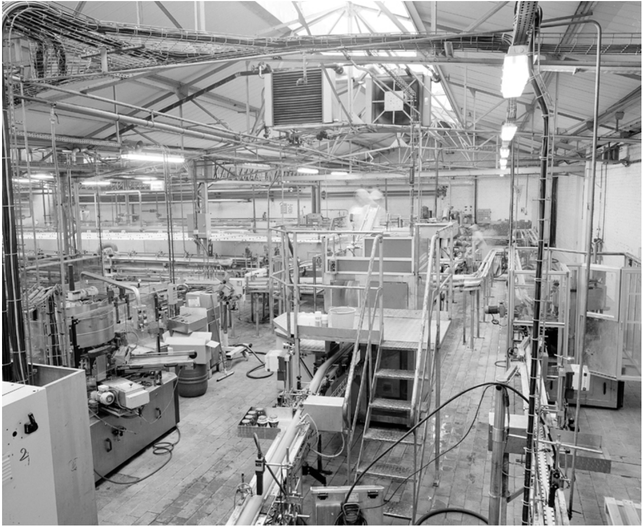
Partie de la chaîne de fabrication où les pots de confiture reçoivent une collerette ou une étiquette puis l'impression d'une date de péremption.
