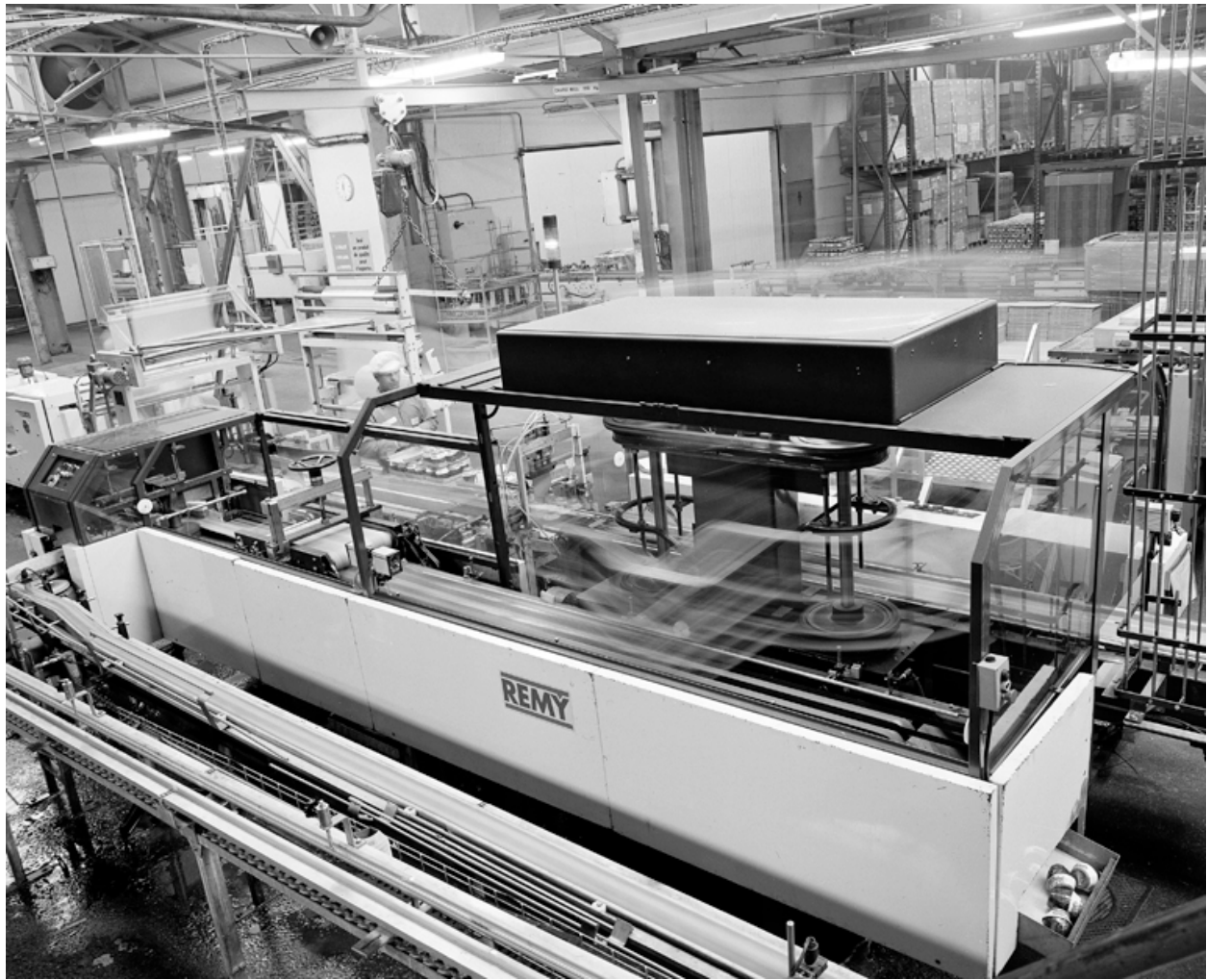
Machine (dite fardeleuse) où les pots de confiture sont groupés par 6 puis emballés dans un film plastique.
