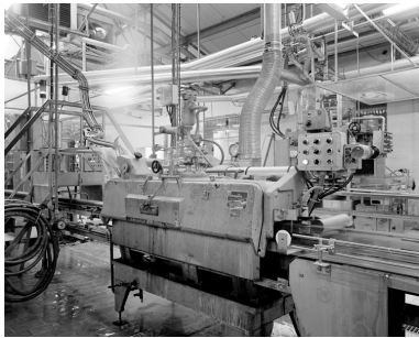
Machine qui capsule sous vapeur les pots de confiture après remplissage. Phot. Thierry Lefébure IVR22_19950202971X
