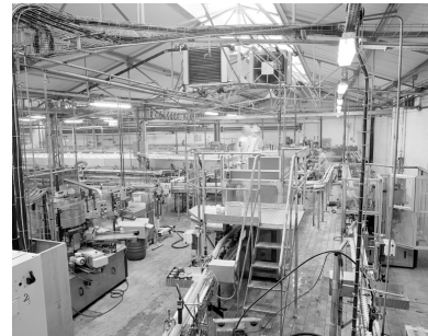
Partie de la chaîne de fabrication où les pots de confiture reçoivent une collerette ou une étiquette puis l'impression d'une date de péremption. Phot. Thierry Lefébure IVR22_19950202973X
