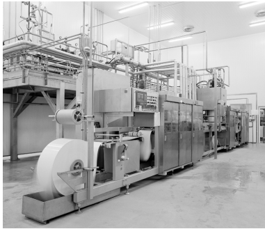
Conditionnement de la compote de pommes : vue d'ensemble de la ligne de thermoformage. Phot. Thierry Lefébure IVR22_19950202977X
