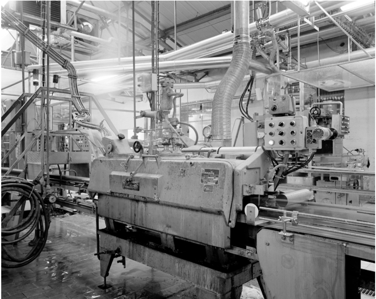
Machine qui capsule sous vapeur les pots de confiture après remplissage.
