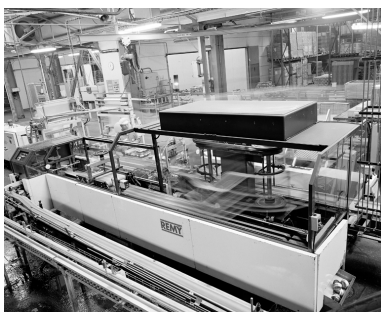
Machine (dite fardeleuse) où les pots de confiture sont groupés par 6 puis emballés dans un film plastique. Phot. Thierry Lefébure IVR22_19950202974X
