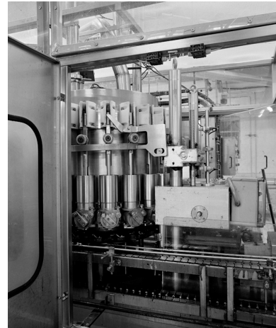
Vue de la machine qui dose la confiture dans les pots de verre. Phot. Thierry Lefébure IVR22_19950202970X
