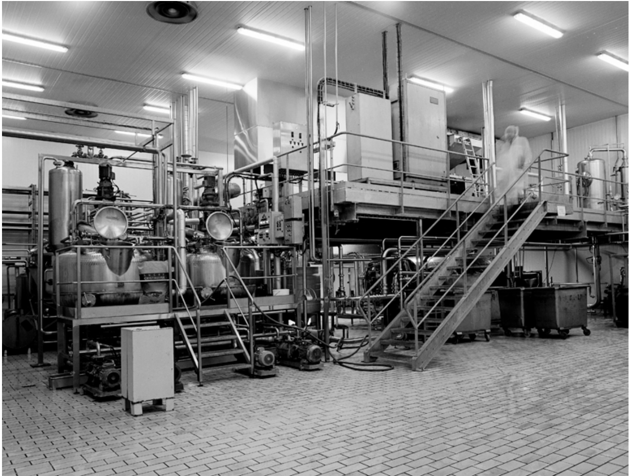
Vue de l'atelier de fabrication de la compote de pommes : machines diverses servant à cuire et mélanger les fruits puis à recueillir les déchets.
