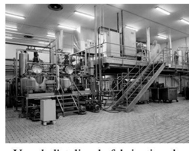
Vue de l'atelier de fabrication de la compote de pommes : machines diverses servant à cuire et mélanger les fruits puis à recueillir les déchets. Phot. Thierry Lefébure IVR22_19950202978X
