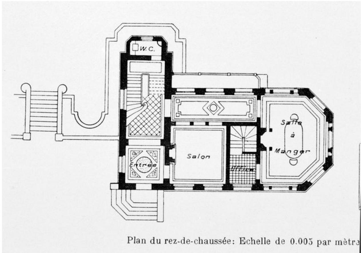
Plan du rez-de-chaussée: Echelle de 0.005 par mètre
