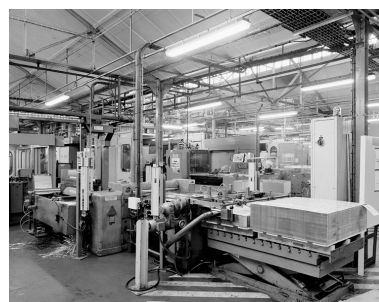
Intérieur de la ferblanterie : début de la chaîne de façonnage des boîtes en métal, à partir de plaques de métal imprimées. Phot. Thierry Lefébure IVR22_19960200135X
