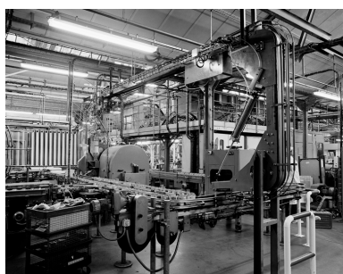
Vue intérieure partielle de la ferblanterie : fabrication des boîtes en métal destinées à contenir le lait en poudre. Phot. Thierry Lefébure IVR22_19960200136X
