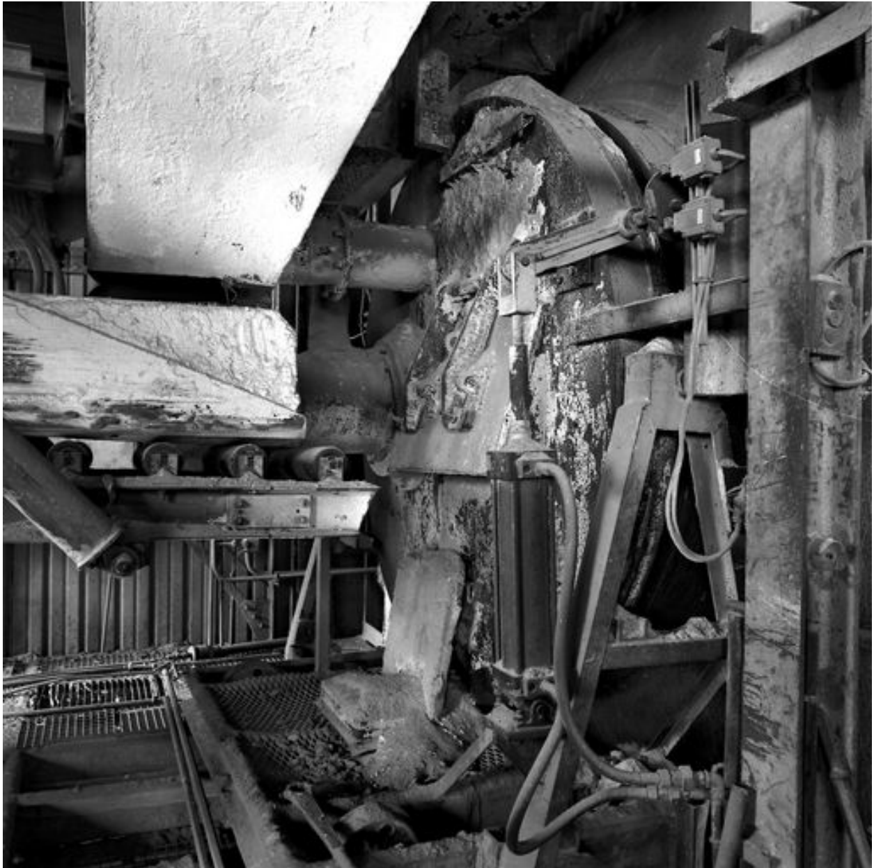
Gueule d'enfournement du four tournant.
