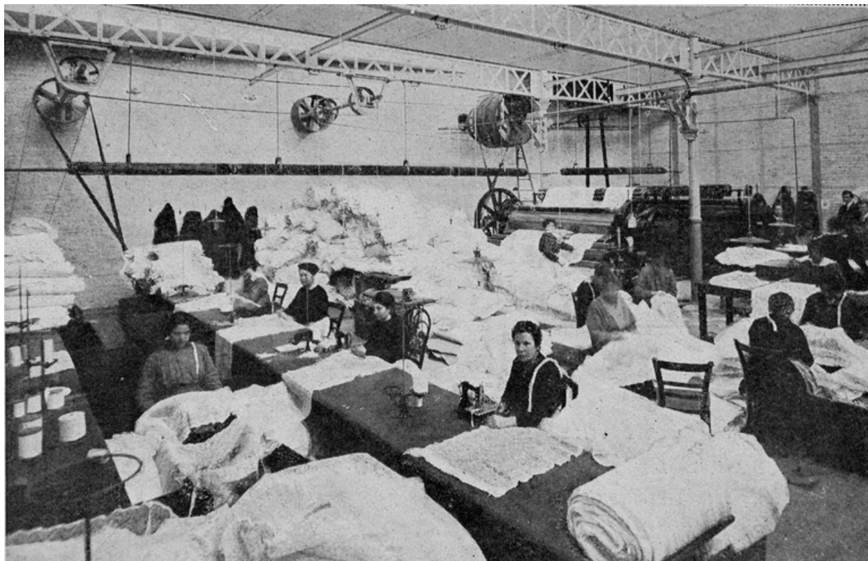
La salle de finissage réorganisée : au premier plan, les machines à border ; au fond à droite, les cylindres qui donnent aux rideaux leur dernier fini, vers 1921 (Le Monde Illustré).
