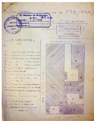
Plan schématique de l'usine, vers 1919 (AD Aisne).
