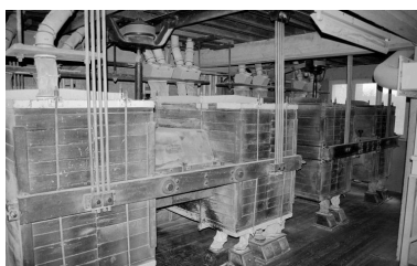
Vue intérieure du 2e étage de la minoterie, vue des planchisters. Phot. Bertrand Fournier IVR22_20006000029Z
