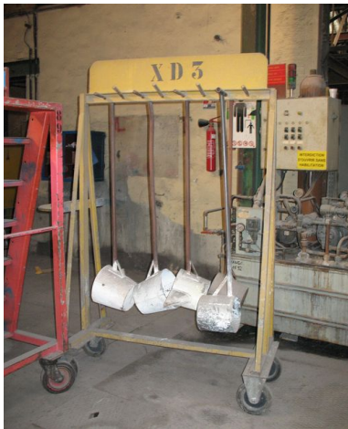
Louches utilisées pour les fours manuels. Phot. Clarisse Lorieux IVR22_20066005102NUCA
