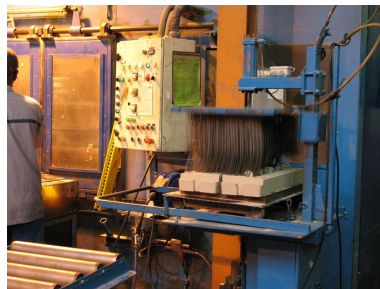
Machine à ébavurer. Phot. Clarisse Lorieux IVR22_20066005086NUCA
