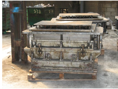
Boîtes à noyaux. Phot. Clarisse Lorieux IVR22_20066005100NUCA
