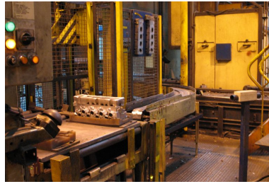
Denoyautage : la pièce vient d'être séparée de son noyau en silice. Phot. Clarisse Lorieux IVR22_20066005092NUCA
