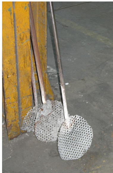
Ecumoire servant à enlever les oxydes de l'aluminium. Phot. Clarisse Lorieux IVR22_20066005103NUCA
