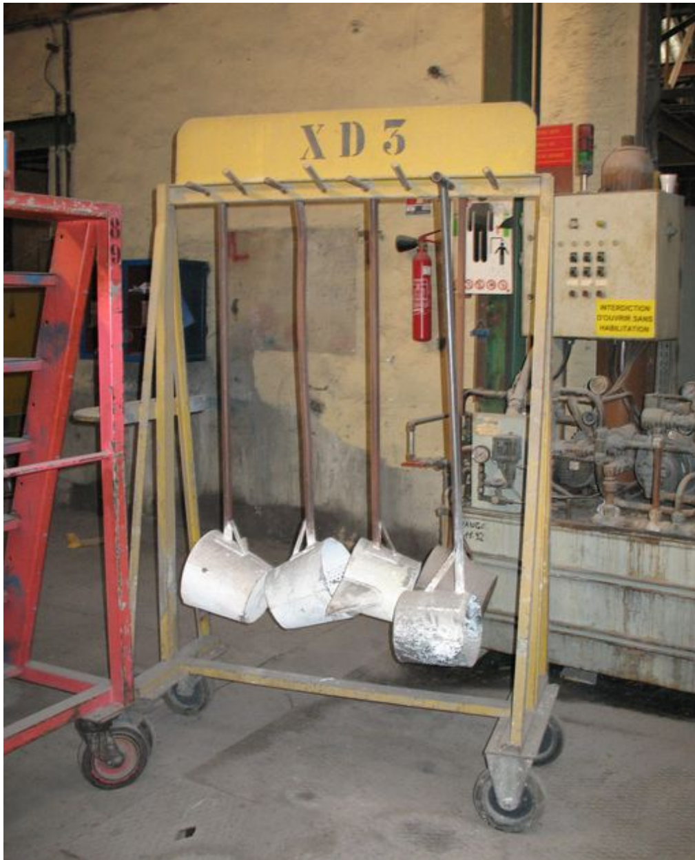
Louches utilisées pour les fours manuels.
