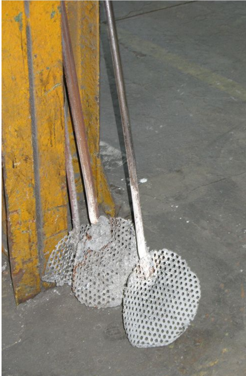
Ecumoire servant à enlever les oxydes de l'aluminium.
