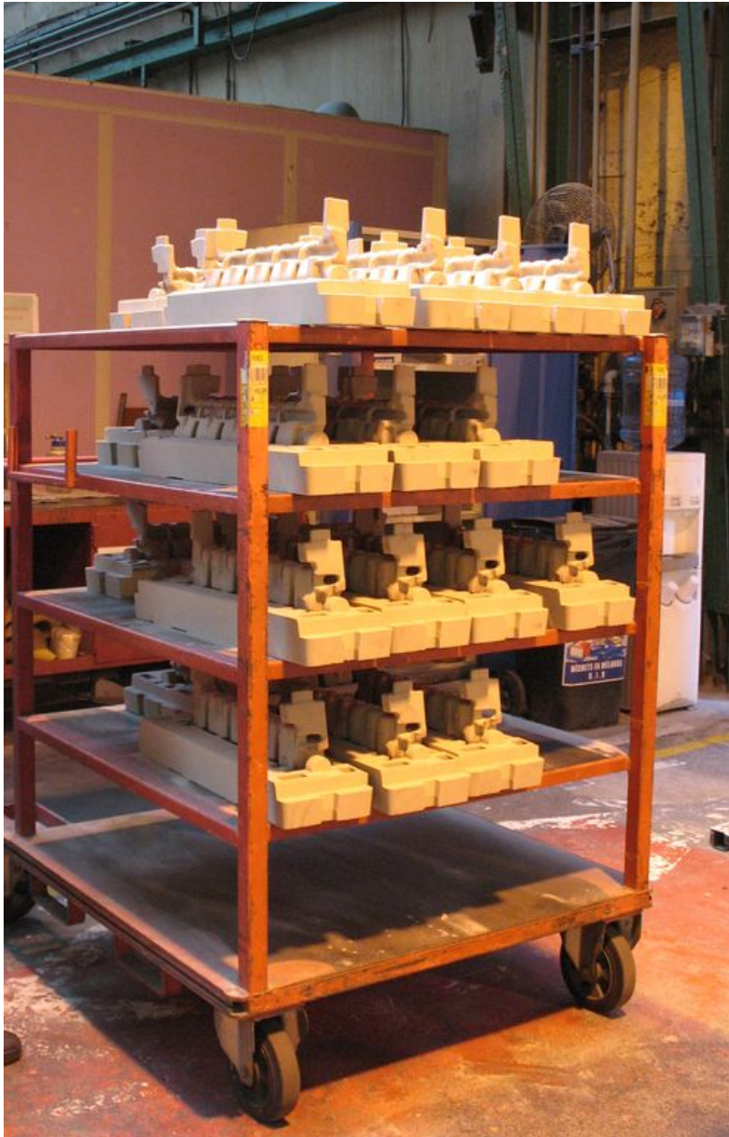
Départ des noyaux pour la fonte.
