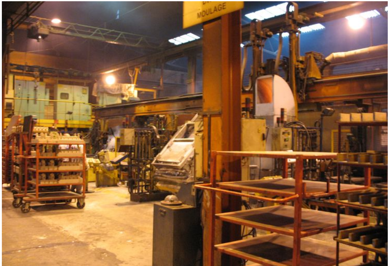
Le chantier en ligne semi-automatisé où les pièces sont coulées à partir des noyaux en sable et résine.
