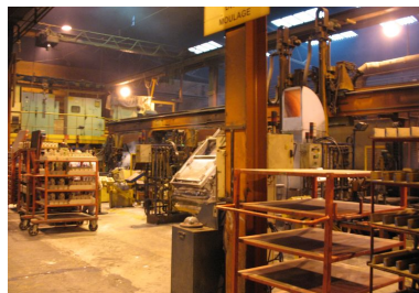
Le chantier en ligne semi-automatisé où les pièces sont coulées à partir des noyaux en sable et résine. Phot. Clarisse Lorieux IVR22_20066005089NUCA
