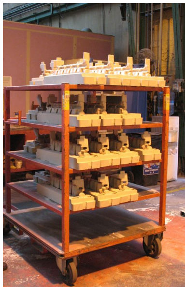
Départ des noyaux pour la fonte. Phot. Clarisse Lorieux IVR22_20066005088NUCA
