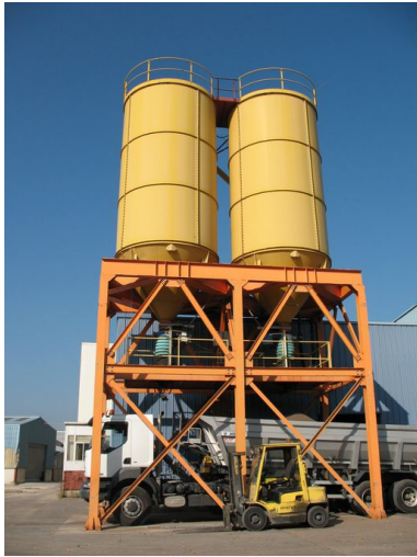
Silos contenant le sable recyclé après concassage et broyage et destiné aux tuileries. Phot. Clarisse Lorieux IVR22_20066005070NUCA
