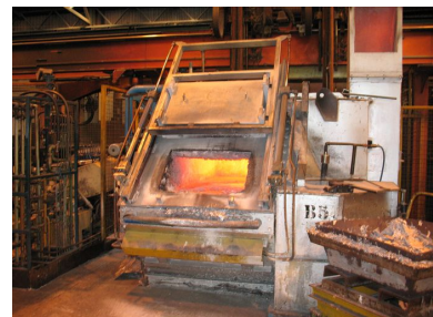
Le four de fusion. Phot. Clarisse Lorieux IVR22_20066005090NUCA
