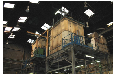
Le traitement thermique des pièces, opération réalisée dans deux fours automatiques, dure 11 heures. Phot. Clarisse Lorieux IVR22_20066005096NUCA
