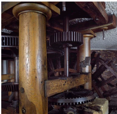
Détail de l'arbre vertical, des deux colonnes en chêne du beffroi et de la roue dentée d'alluchons en bois appelée le hérisson (en bas). Phot. Thierry Lefébure IVR22_20106000472XA
