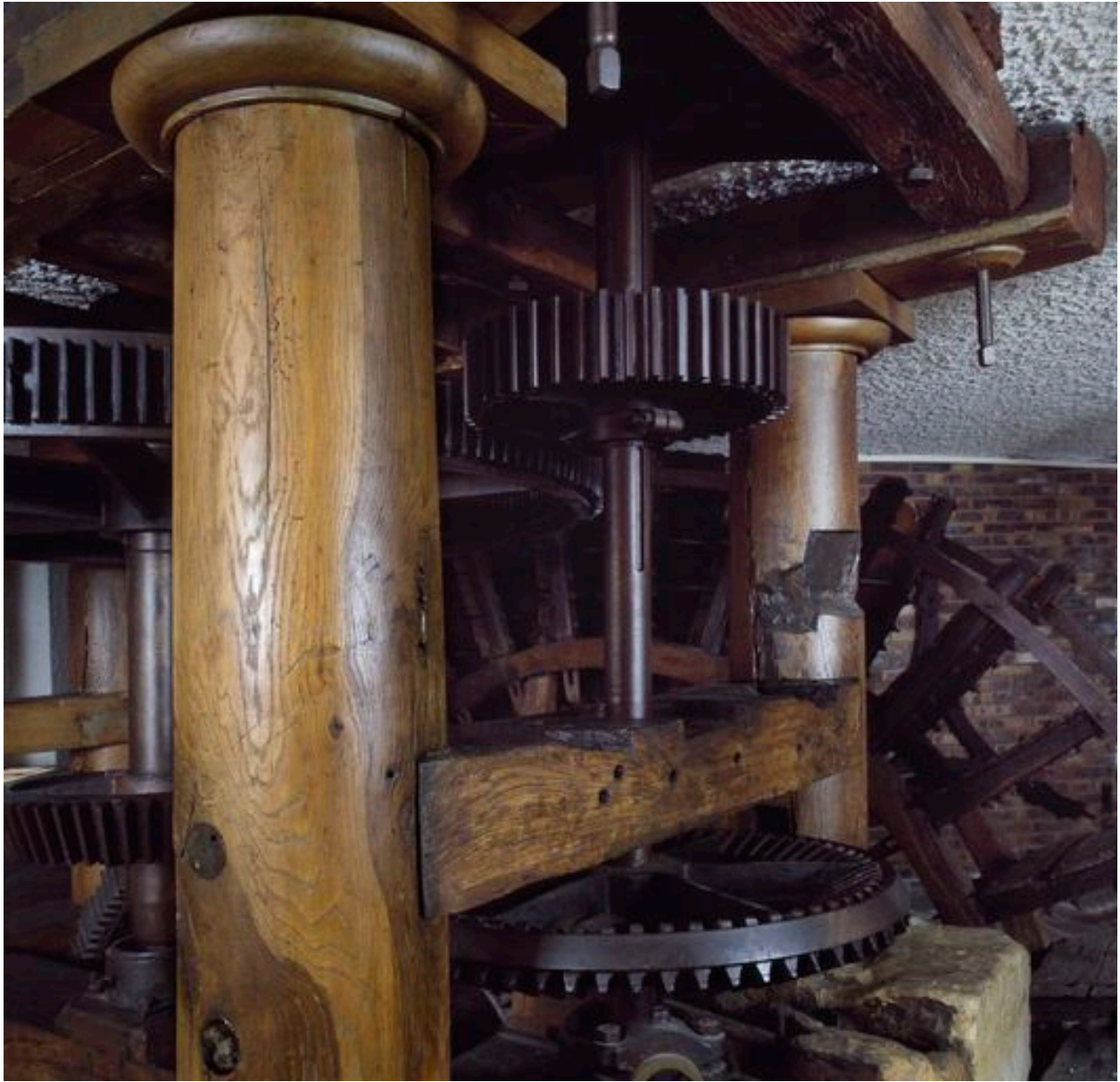
Détail de l'arbre vertical, des deux colonnes en chêne du beffroi et de la roue dentée d'alluchons en bois appelée le hérisson (en bas).
