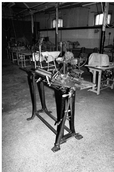
Machine à tricoter à la main, vers 1925-1930. Phot. Benoît Dufournier IVR22_19878000439Z
