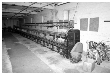
Machine continue à filer N.S.C. datant de 1923. Phot. Benoît Dufournier IVR22_19878000434Z
