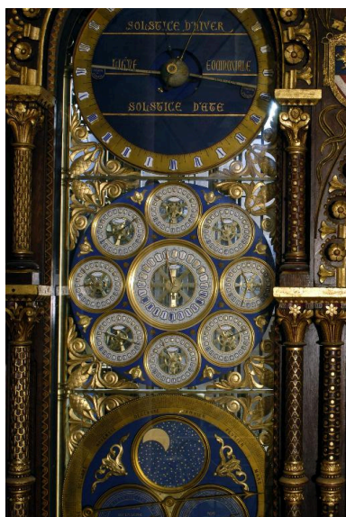
Vue de détail des cadrans situés au centre de la baie gauche, indiquant l'heure moyenne civile du méridien de Paris et de 8 villes à l'Ouest. Phot. Thierry Lefébure IVR22_20046000027NUCA
