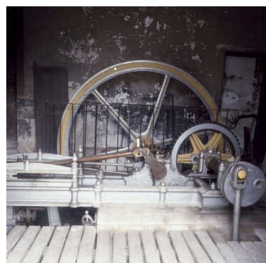
Vue de face du mécanisme : volant, pignon, roue de réducteur, manivelle et bielles du piston. Phot. Thierry Lefébure IVR22_20006000640XA
