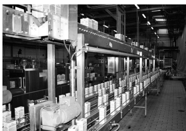
Atelier de conditionnement du lait : détail des tapis de transports des brick de lait. Phot. Bertrand Fournier IVR22_20006000246Z
