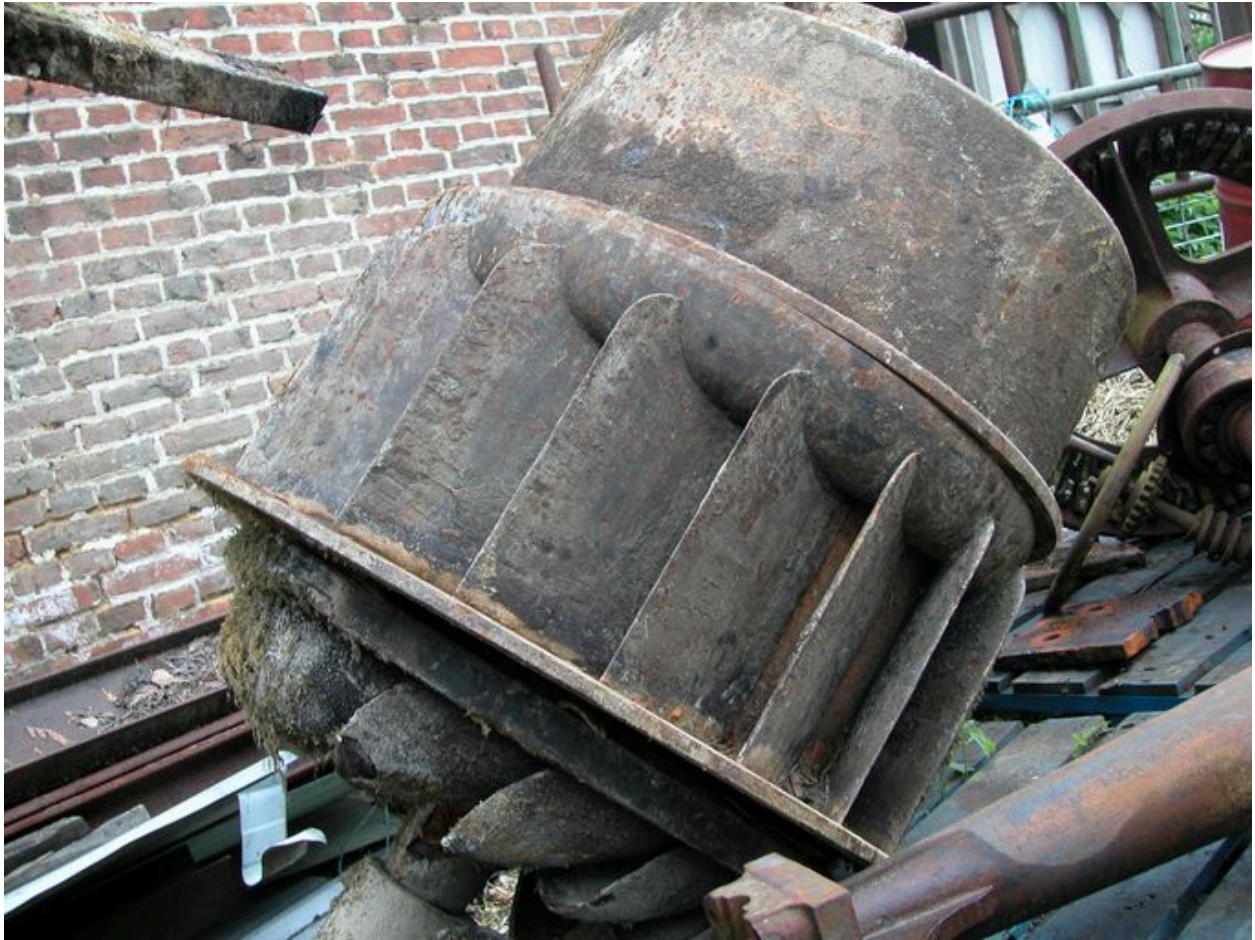
Vue d'ensemble de la turbine démontée.
