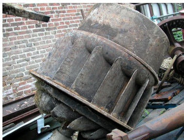
Vue d'ensemble de la turbine démontée. Phot. Bertrand Fournier IVR22_20056000836NUCA
