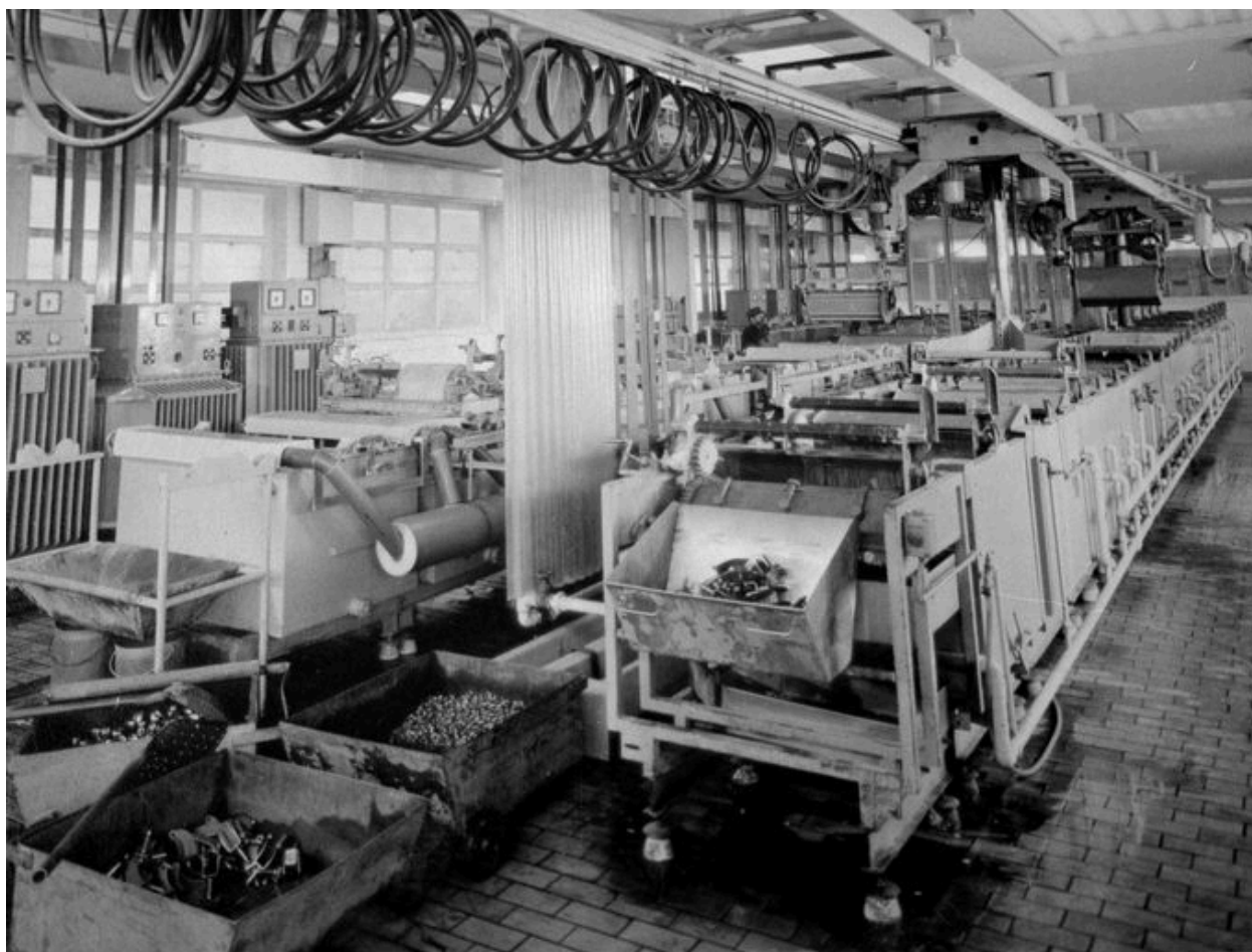
Chaîne tonneau d'electro-zingage des pièces métalliques utilisées dans la fabrication des roulettes, vers 1970 (AP).
