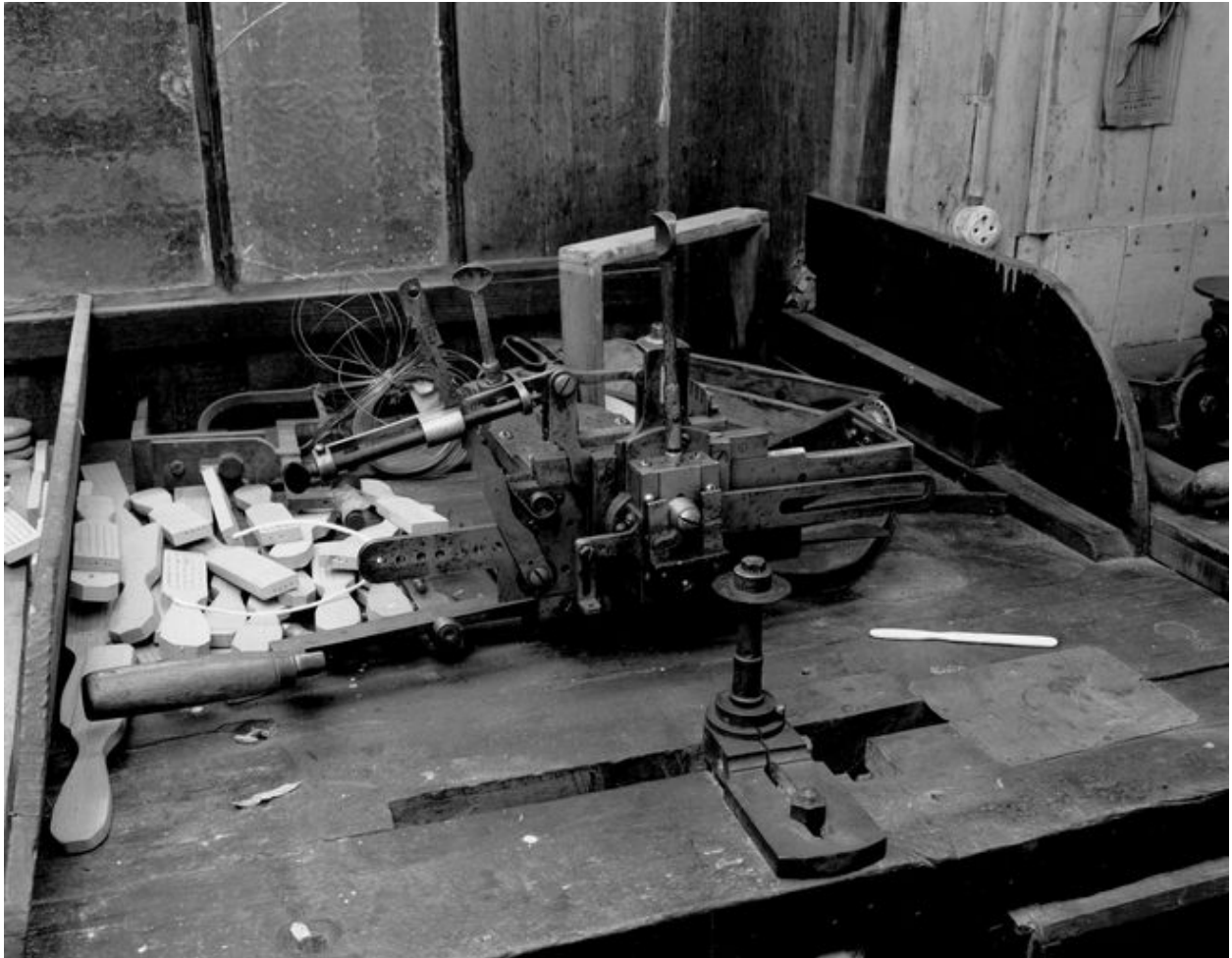
Vue d'ensemble de la machine à rainurer.
