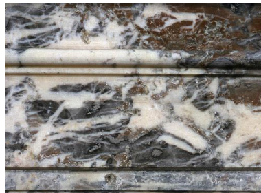
Détail de l'un des marbres (brèche) entrant dans la composition du devant de l'autel Saint-Gervais. Phot. Marie-Laure Monnehay-Vulliet IVR22_20010202552ZA
