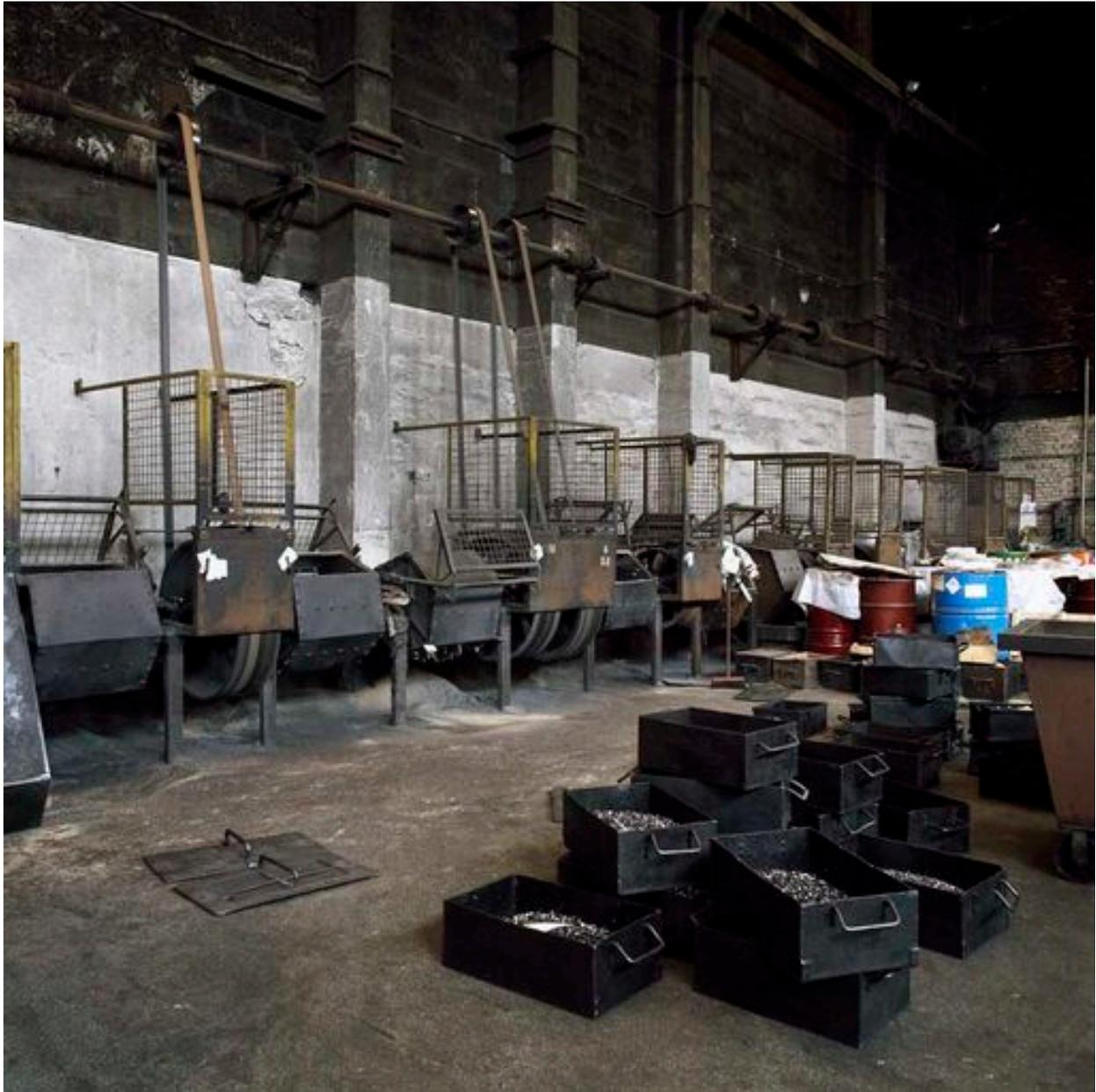
Une fois fabriqués, les clous sont polis dans les frottoirs avec de la sciure qui absorbe la graisse et donne au clou son aspect brillant.
