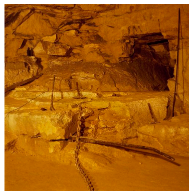
Chantier de taille et ses outils : aiguille, barre à loper, treuil et scie. Phot. Thierry Lefébure IVR22_20106000821XA
