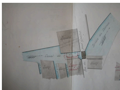
Plan partiel de la broserie Ménard, annexé à la demande de Leroy de planter des colonnes en fonte dans le canal pour soutenir un bâtiment, 1895.
