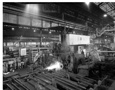
Les laminoirs (usine C). Vue générale du perceur Meer-Mannesmann AG, datant des années 1930. Au premier plan, le tube en cours de perçement.
