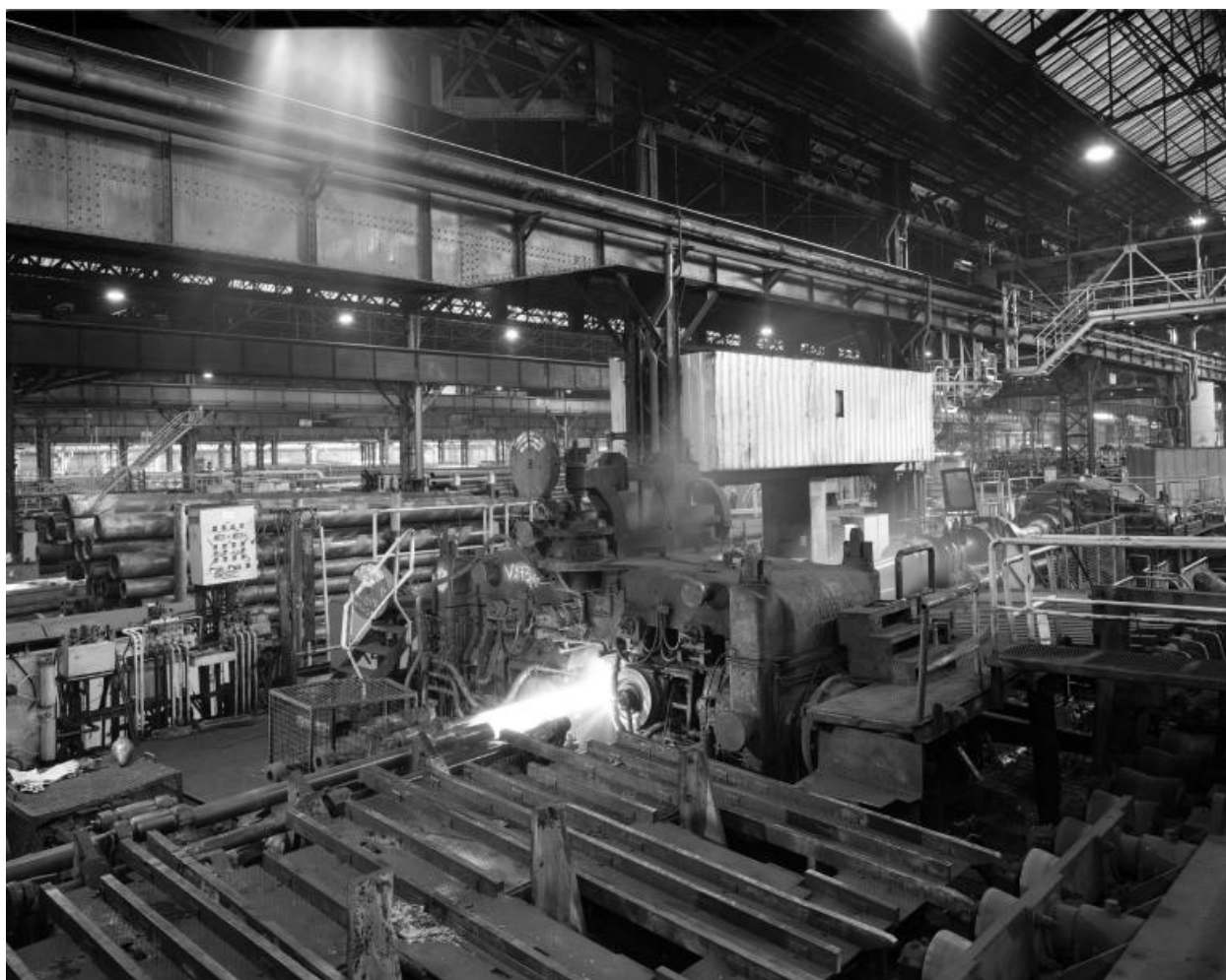
Les laminoirs (usine C). Vue générale du perceur Meer-Mannesmann AG, datant des années 1930. Au premier plan, le tube en cours de percement.
