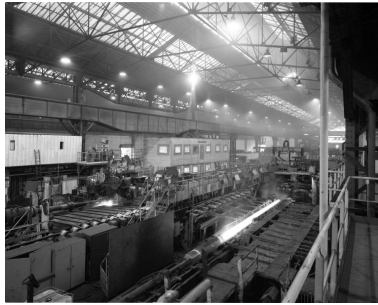
Salle des laminoirs (usine C). Vue générale de l'élongateur. Le tube vient d'être percé et va être étiré. Phot. Thierry Petitberghien IVR31_20025900340V
