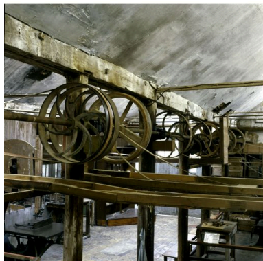
Détail des poulies et courroies alimentant les différentes machines de l'atelier. Phot. Thierry Lefébure IVR22_20046000341XA
