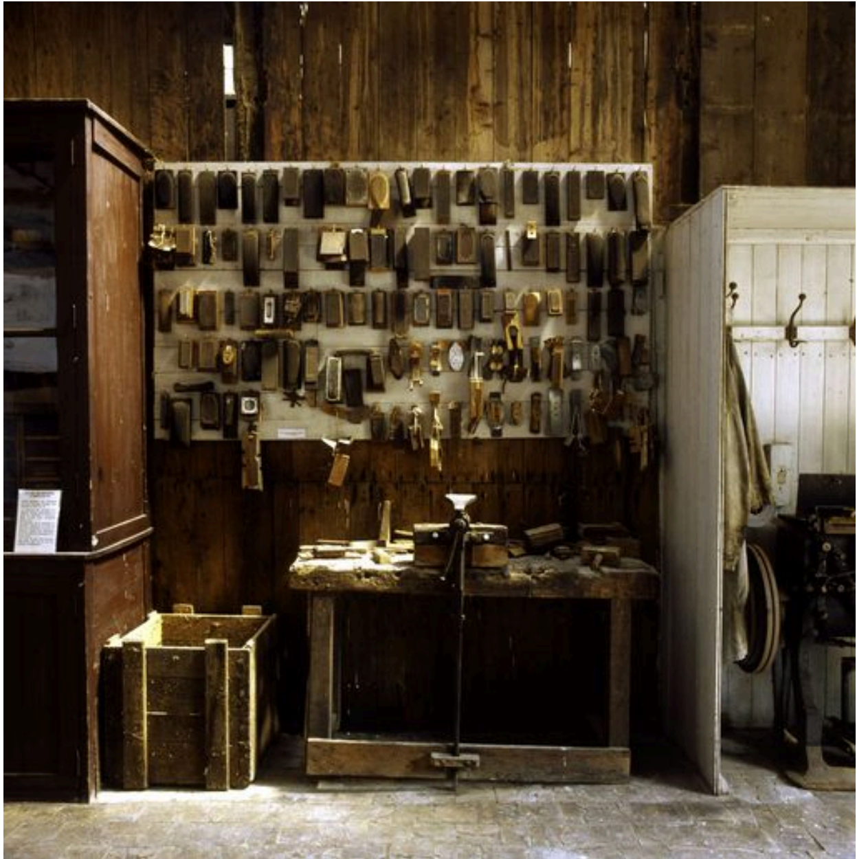
Détail des gabarits utilisés pour le perçage des brosses.
