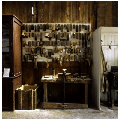
Détail des gabarits utilisés pour le perçage des brosses. Phot. Thierry Lefébure IVR22_20046000266XA
