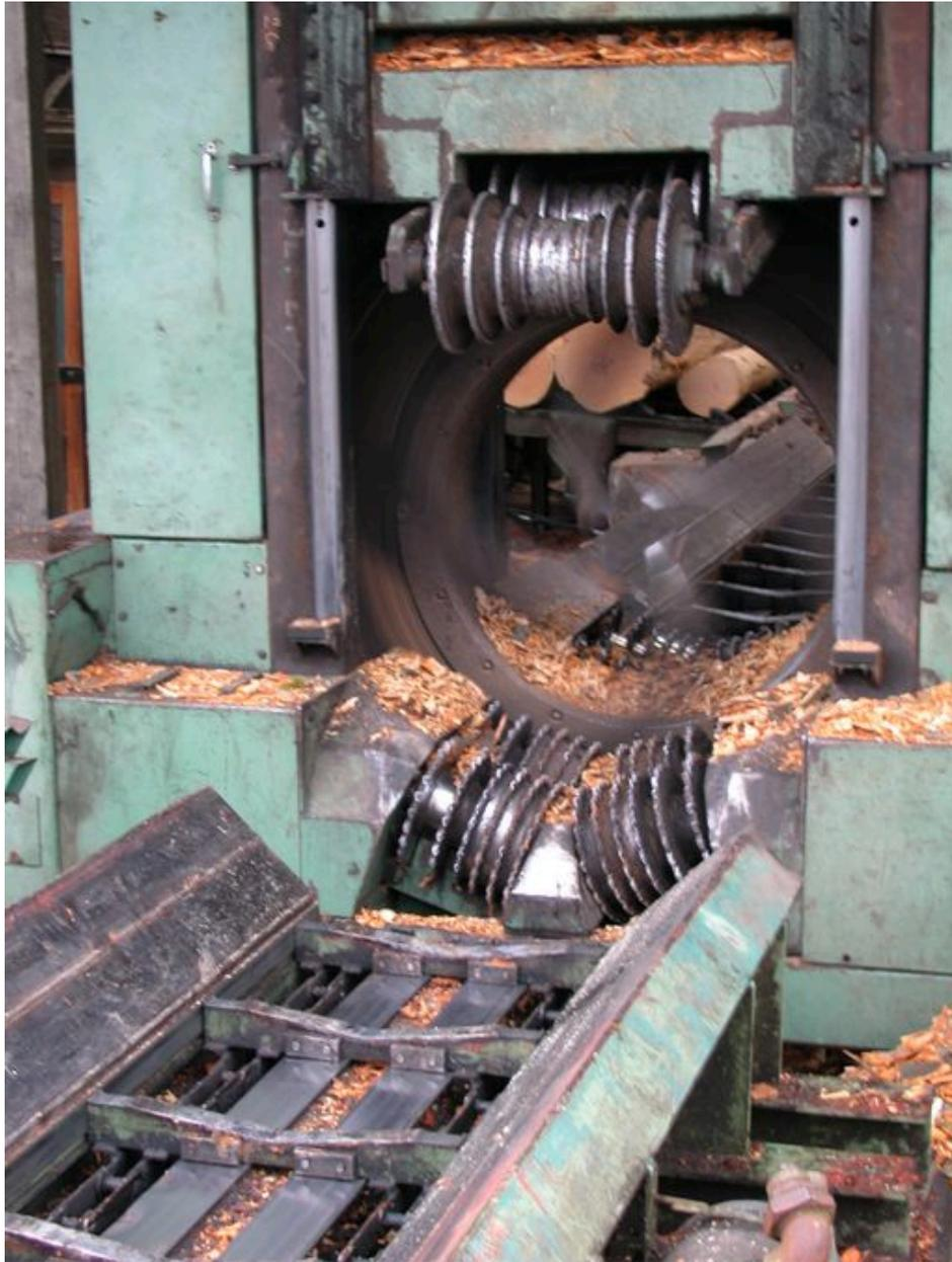
Machine à écorcer les grumes avant sciage.
