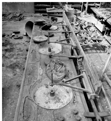
L'atelier de fabrication reconstruit après la guerre, banc de polissage. Phot. Patrick Glotain IVR22_19936000521X
