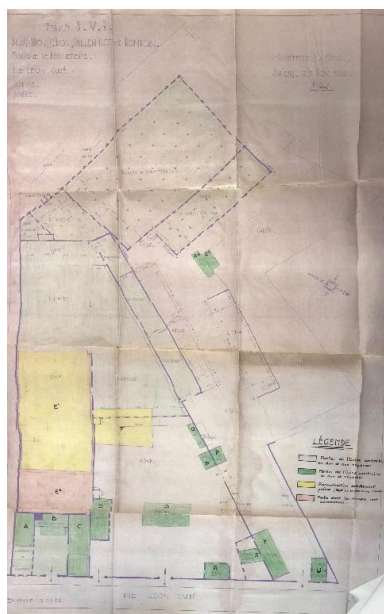
Plan de reconstruction de l'usine de bonneterie B.V.R à Corbie [en vert clair : partie de l'usine construite en dur et non réparée ; en vert foncé : partie de l'usine construite en dur et réparée ; en jaune : construction actuelle prévue ; en rose : partie dont les travaux sont commencés], par M. Thorel, 29 novembre 1941 (AD Somme ; 1254 W 154).
