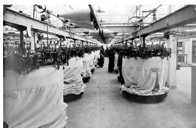
Batterie de métiers circulaires, photographie, 1957 (archives privées de l'entreprise). Phot. Philippet Jacques IVR22_19878000288XB
