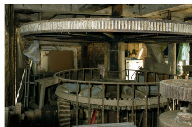
Le beffroi du moulin et les grands rouets de transmission. Phot. Thierry Lefébure IVR22_20056000066NUCA
