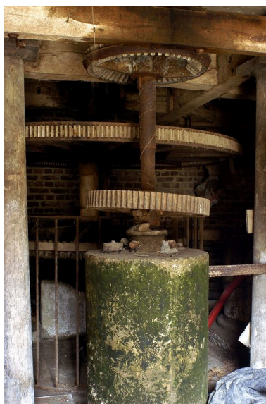
Détail des engrenages de transmission vers l'une des meules du premier étage. Phot. Thierry Lefébure IVR22_20056000065NUCA
