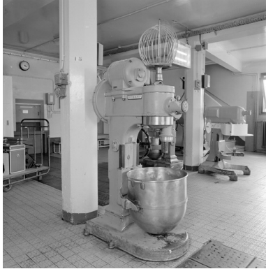
Machine à émulsionner de fabrication française, compagnie Hobart, vers 1935. Phot. Thierry Lefébure IVR22_19950200452X
