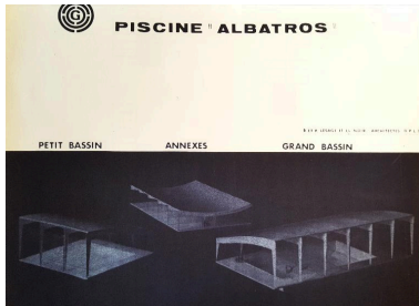
Les trois modules de base de la piscine "Albatros" : module petit bassin, module grand bassin et module annexes (AN ; 19840036/55). Phot. Laurence Schlosser (reproduction) IVR32_20170205326NUCA
