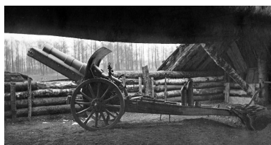
Canon Krupp de 150 mm du type de ceux accueillis dans ces deux postes d'artillerie (Archives privées) Phot. Jean-Marc Ramette IVR32_20175900329NUCA
