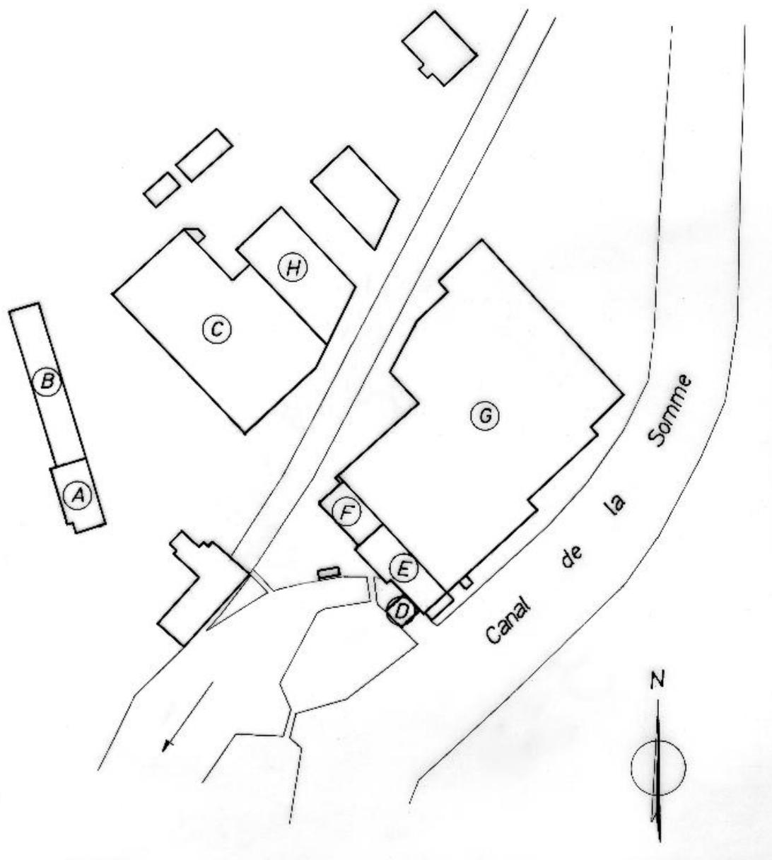
Schéma de situation : A. Conciergerie, B. Ecuries, entrepôts, C. Magasin industriel, D. Bâtiment d'eau, E. Chaufferie, salle des machines, F. Bureau, G. Ateliers de filature, H. Atelier de teinturie.
