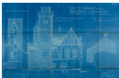
Ville de Bapaume - reconstruction de l'hôtel de ville - place Faidherbe et rue d'Arras : coupe sur l'axe de la tourelle ; coupe transversale sur salle des fêtes et façade sur la cour ; pignon mitoyen avec la propriété de M. Dengreville. Signé et daté Eugène Bidard (architecte) et
