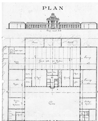
Plan et élévation d'une imprimerie
