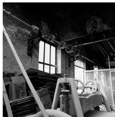
Atelier de fabrication. Presse à découper le cuir, axe de transmission. Phot. Philippe Dapvril IVR31_19885901210X
